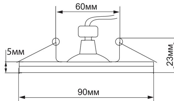
Элегантный встраиваемый светильник **DL8060** TM Feron украсит интерьер и предоставит возможность дополнительной подсветки помещения. Светильник может устанавливаться как в подвесные, так и в натяжные потолки. В качестве основного источника света используются лампы MR16. Толщина стекла 5 мм.
